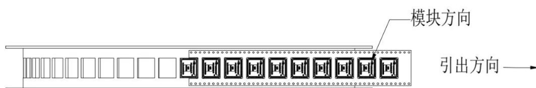
图 26 模块在载带位置和方向
